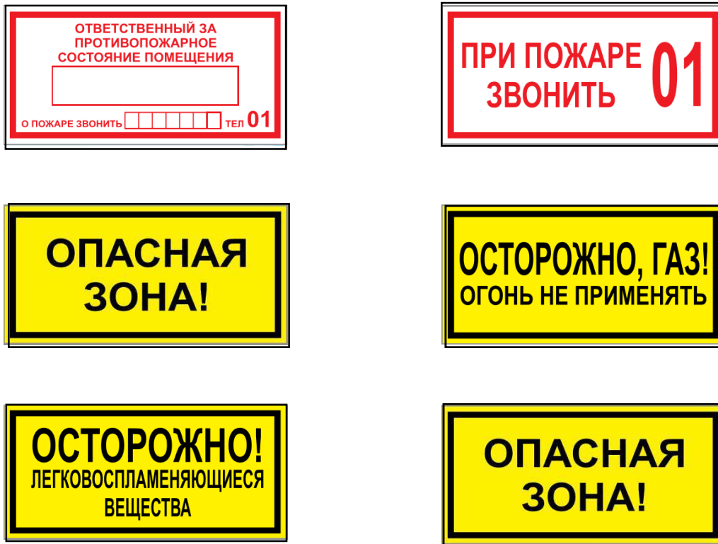
Рисунок Г.3 – Примеры дополнительных знаков безопасности
